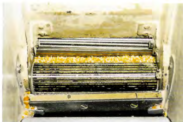
Fig. 16 - 'granaröl; in basso si vede il cilindro superiore; fissata da viti la barra scura della calamita
